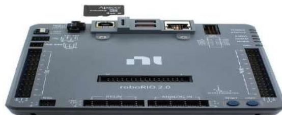
Imagem 2.1.4 RobôRIO- processamento de conexão modelo RIO 2.0 usado como cérebro do robô.
